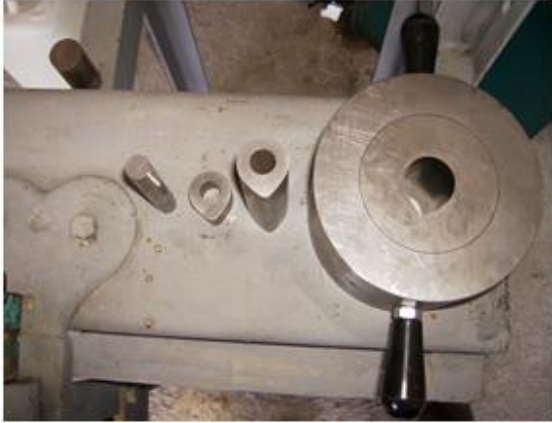
Şekil 1: Üretilen kam kalıbı ve parçaları
