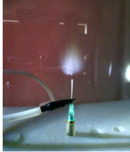
a. Elektro-eğirme deney düzeneği b. İğne ucunda nanoelyaf oluşumu Şekil. 1 Elektro-eğirme deney düzeneği ve lif oluşumu
